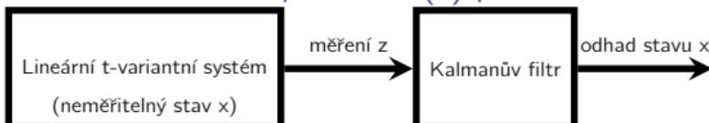
Odhad náhodného procesu  $x(t)$  pomocí nelineárního filtru
