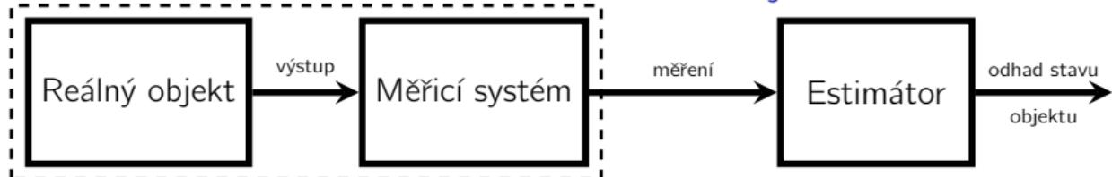
blokové schéma popisující úlohu odhadu
